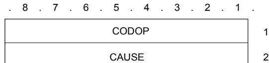
**Figure 55: D\_HOOK\_ON\_INVITATION TSDU format**
